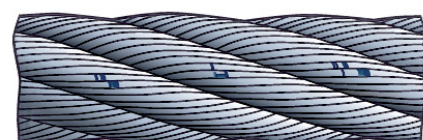
fils cassés au niveau des "parures"
