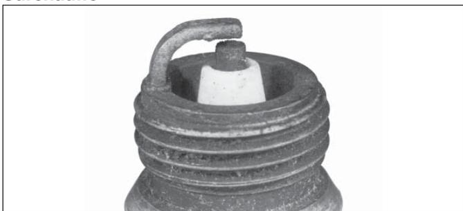
Des dépôts calcaires blancs indiquent des températures de combustion très élevées. Cette condition est en général accompagnée d'une érosion excessive de l'écartement. Des réglages pauvres du carburateur, une fuite au niveau de l'admission d'air ou un calage incorrect de l'étincelle sont les causes les plus communes des températures de combustion élevées.
