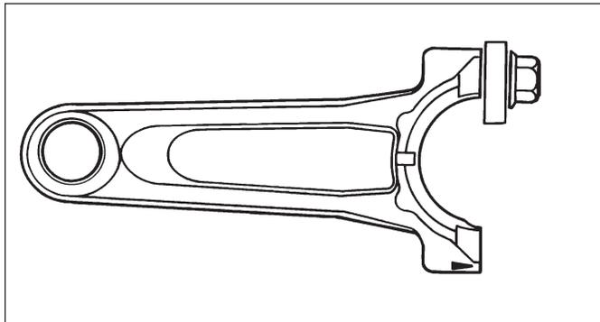
Une clé à ergots pour lever les culbuteurs ou pour tourner le vilebrequin peut être fabriquée avec une vieille bielle.
