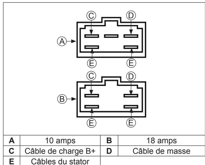
REMARQUE : Lors du montage du redresseur-régulateur, branchez la prise du faisceau de câblage dans la prise du régulateur jusqu'à ce qu'il soit verrouillé.
