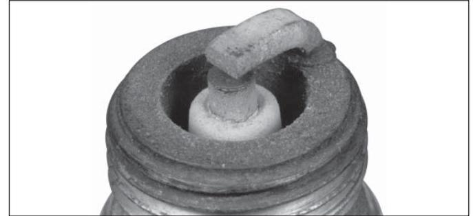
Une bougie provenant d'un moteur fonctionnant dans des conditions normales est recouverte d'une légère couche de dépôts gris ou jaune. Si l'électrode centrale n'est pas usée, la bougie peut être réutilisée une fois l'écartement contrôlé.
