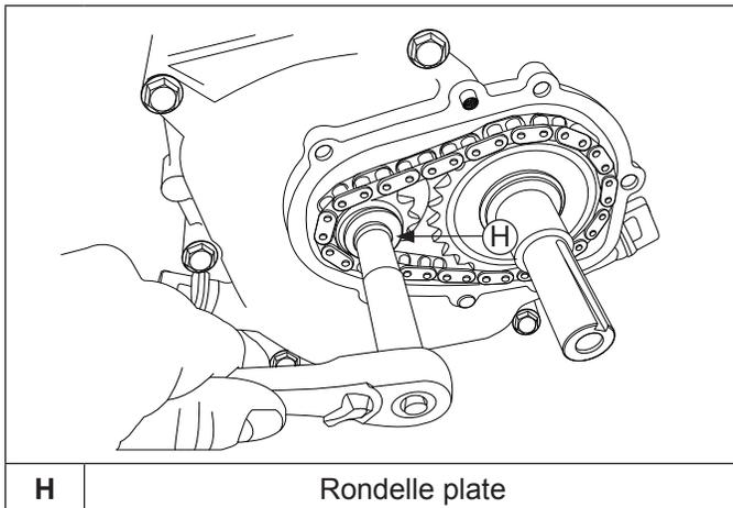
6. Retirez avec précaution l'ensemble, pignon cannelé, chaîne, roue dentée de prise de mouvement et rondelle élastique.
