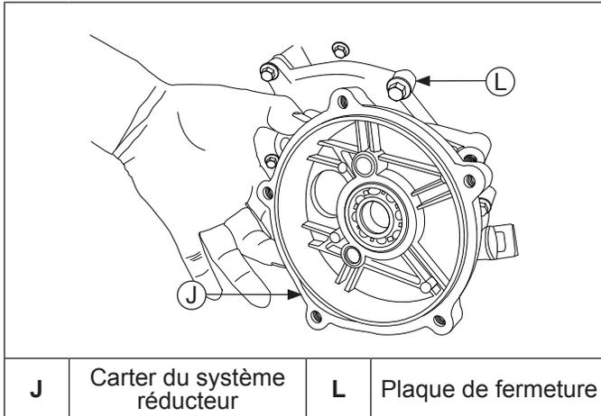
3. Graissez et installez l'arbre de prise de mouvement dans le carter du système réducteur. Enclenchez les dents avec les cannelures sur le vilebrequin et glissez l'ensemble dans l'alésage du roulement sur le boîtier.
