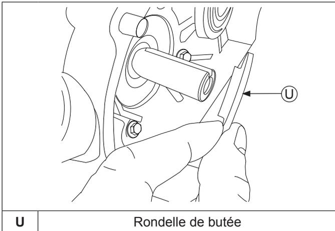
10. Si l'entretien nécessite la dépose du carter du système réducteur, retirez les vis fixant le carter à la plaque de fermeture.
