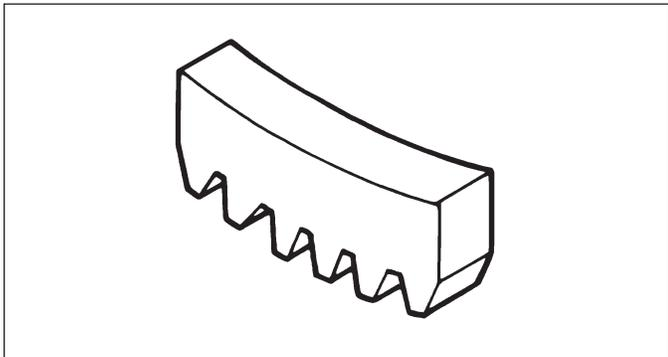
Un outil de maintien de volant peut être fabriqué à partir d'une ancienne couronne dentée de volant et utilisé à la place d'une clé spéciale.
