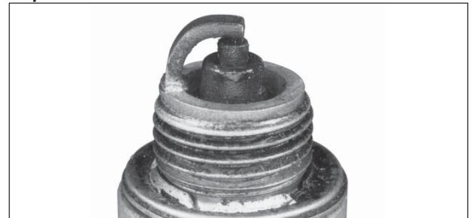
L'humidité sur une bougie est causée par un excès de carburant ou d'huile dans la chambre de combustion. L'excès de carburant peut être dû au colmatage du filtre à air, à un problème de carburateur ou à une utilisation du moteur avec le starter trop ouvert. La présence d'huile dans la chambre de combustion est généralement due à un filtre à air bouché, un problème de reniflard, des segments de piston ou des guides de soupape usés.
