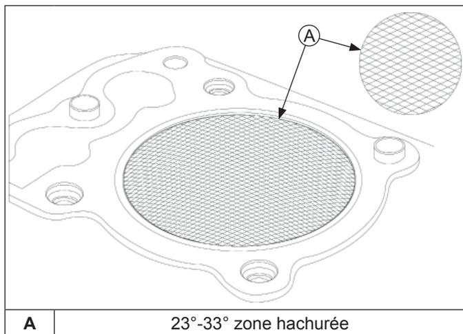
**REMARQUE :** Les pistons Kohler sont usinés aux tolérances précises. Quand un cylindre est surdimensionné, il doit être usiné à exactement 0,25 mm (0,010 po) de plus que le nouveau diamètre (Spécifications et tolérances). Le piston de rechange Kohler surdimensionné s'adaptera alors parfaitement au cylindre.
