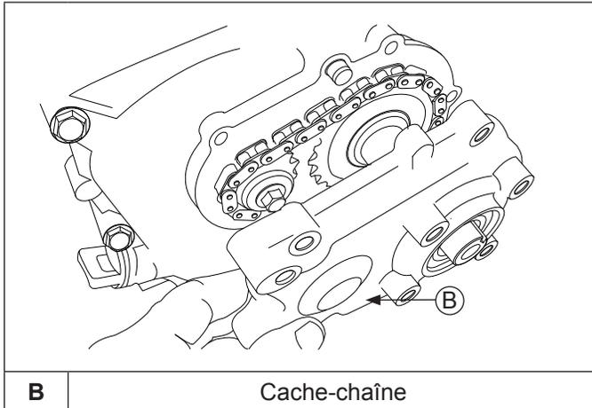
5. Retirez la vis et la rondelle plate fixant le pignon cannelé au vilebrequin.
