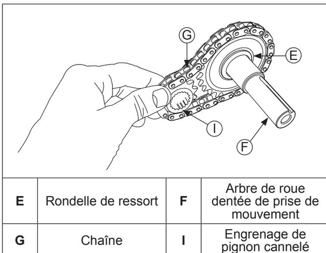
7. Le cas échéant, retirez du vilebrequin, l'entretoise du pignon arrière. Notez la position de la rondelle élastique sur le côté extérieur de l'arbre de roue dentée de prise de mouvement.
