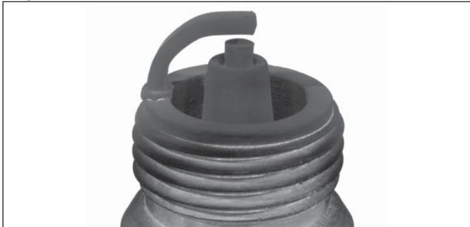
Des dépôts de suie noirs indiquent une mauvaise combustion due à un filtre à air colmaté, un mélange de carburant trop riche, un allumage faible ou une compression de mauvaise qualité.
