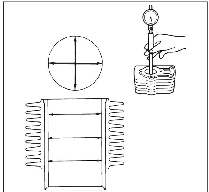
REMARQUE : Une surdimension de 0,25 mm (0,010 po) du piston est possible si le redimensionnement est sélectionné. Commencez la remise au format avec une barre d'alésage, puis suivez les méthodes d'alésage du cylindre.
