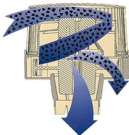
1- A l'entrée du Turbo III, l'air entre en rotation entraînant une turbine.
